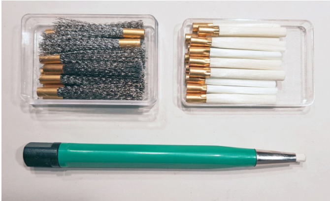
Abb. 8: Glasradierer mit den beiden üblicherweise verwendeten Einsätzen aus Stahl und Glasfaser
