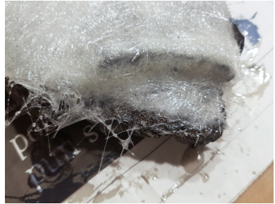
Abb. 4: Detailansicht mit abstehenden Glasfasern
