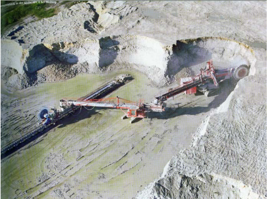
Abb. 4: Mergelgrube Teutonia Nord der Heidelberg Zement mit modernem Schaufelradbagger und Förderbändern
